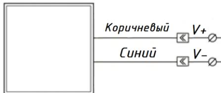
Рис. Схема подключения панели WHITE.
