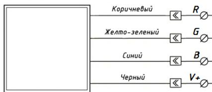
Рис. Схема подключения панели RGB
